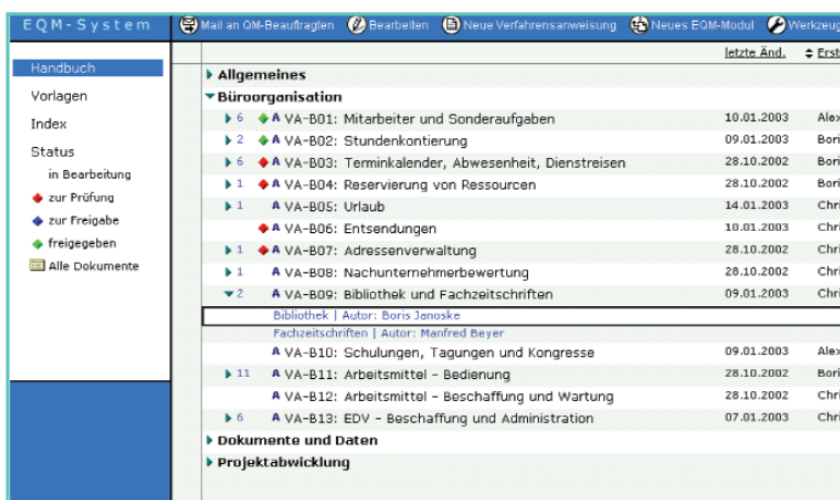
Abb. 2: Ausschnitt des QM-Handbuchs. Es zeigt den aktuellen Prüfstatus der Verfahrensanweisungen anhand der jeweiligen Farbe der Raute-Symbole.
